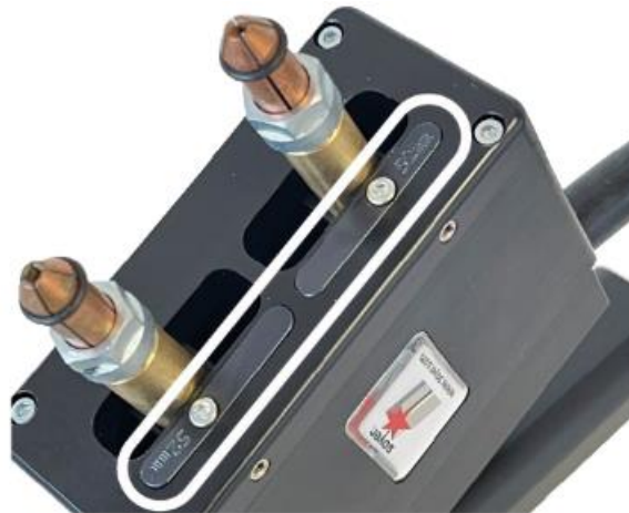
8. ábra: a csaptávolság két távtartó segítségével rögzítve van
